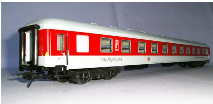
Die Türöffnungen werden mit Schwarzstift nachgezogen weil die Schlussbeleuchtung Signalrot eingefärbt wird oder mit Leds bestückt, und fertig ist der **City Night Line Wagen Bcvmz 248.1**.
